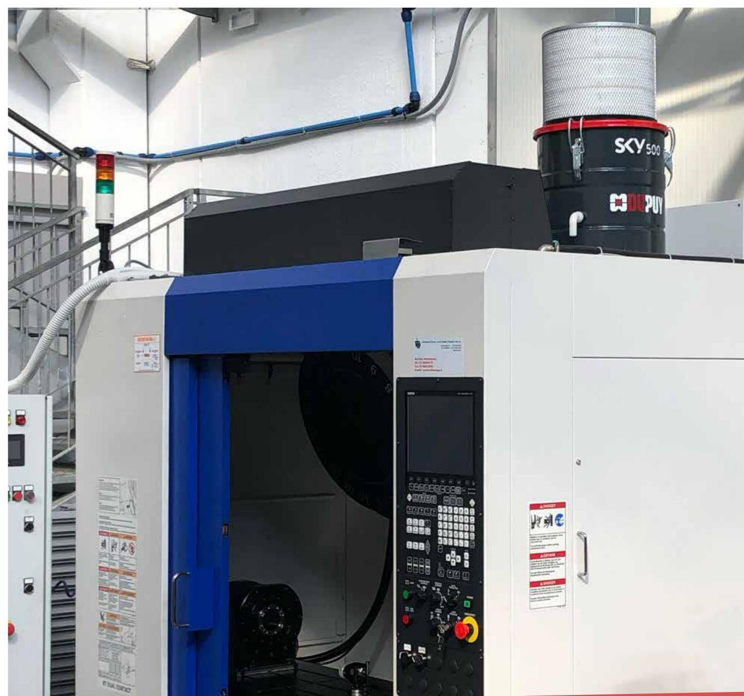
Nová rada filtrov olejovej hmlí DU-PUY pozostáva zo širokej škály modelov s prietokom vzduchu v rozmedzí od 250 do 2500 m<sup>3</sup>/h, ktoré môžu filtrovať nečistoty z akéhokoľvek typu obrábacieho stroja. **Vďaka vysoko výkonným ventilátorom sú schopné zabezpečiť vysoký prietok vzduchu s veľmi nízkou spotrebou energie.**
